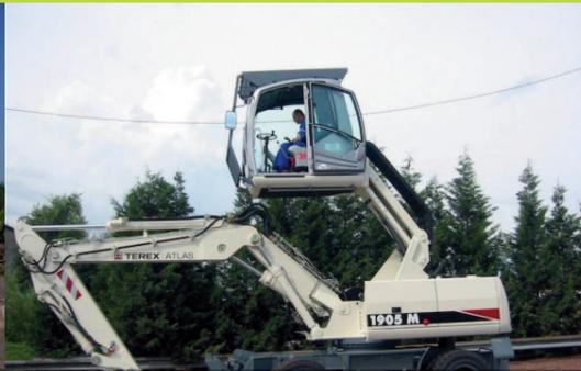
Cabine élévatrice sur machine en version TP.
