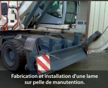
Fabrication et installation d'une lame sur pelle de manutention.
